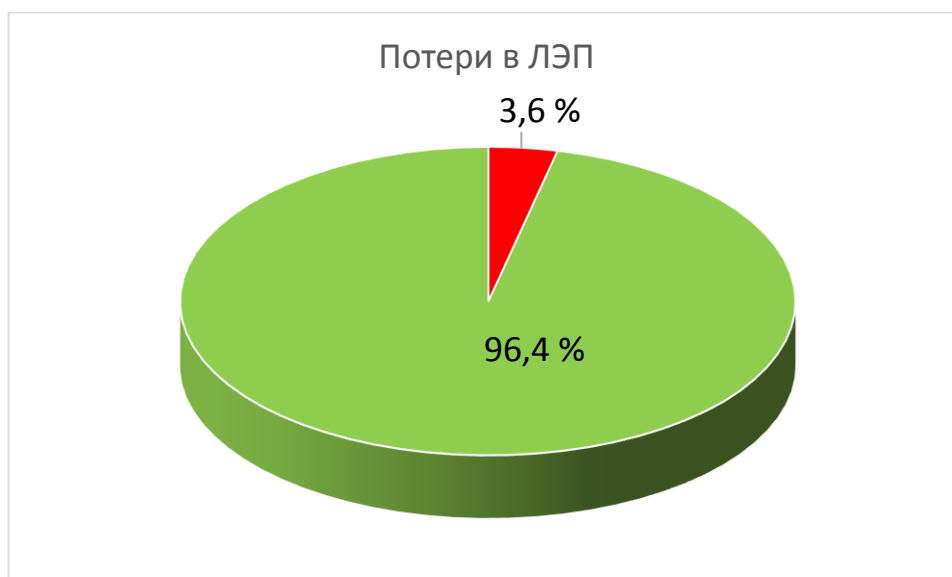
Рисунок 20 – Потери в ЛЭП после установки СТК
