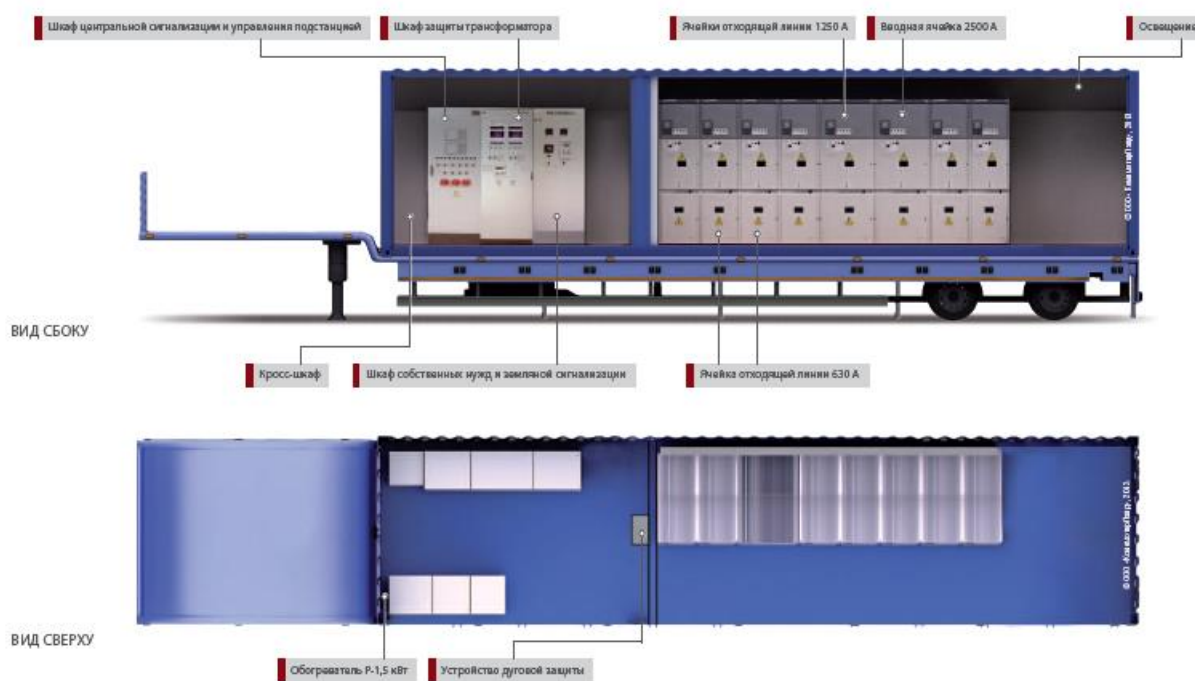
Рисунок 24 – Вид 3 модуля 10 кВ ММПС 110/10
