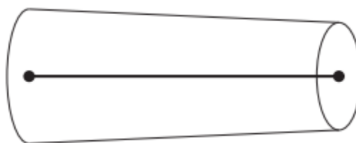
Рисунок 47 – Одномерный конечный элемент с двумя узлами
