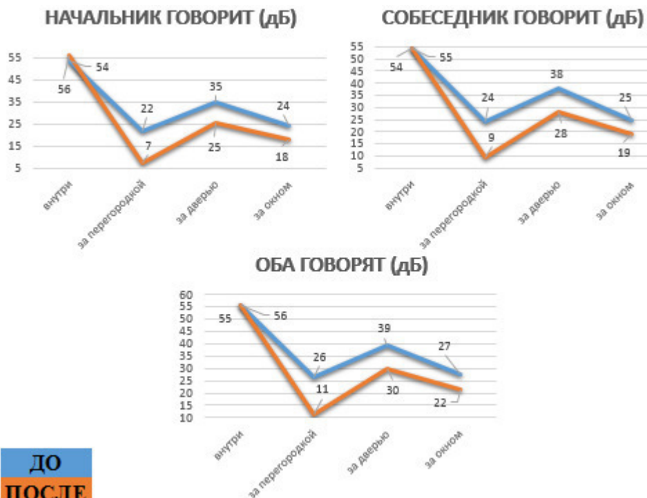
Рисунок 85 – Сравнение показателей до и после усиления звукоизоляции без учёта шума от персонального компьютера
