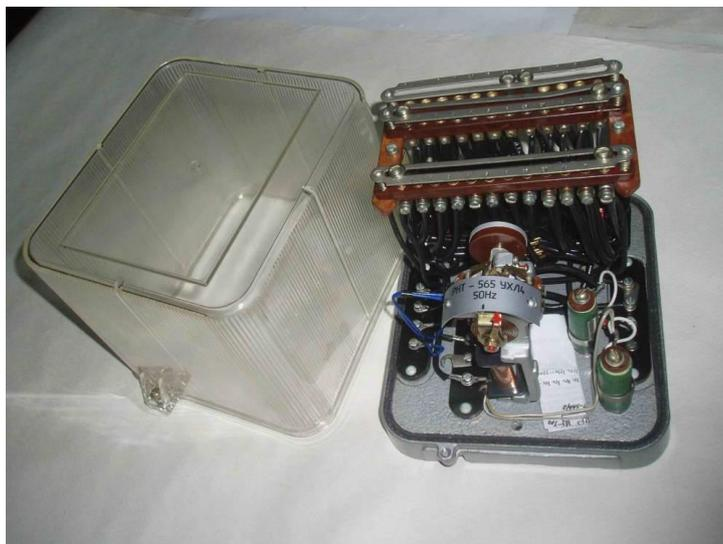
Рисунок 12 – Реле напряжения типа РНТ
