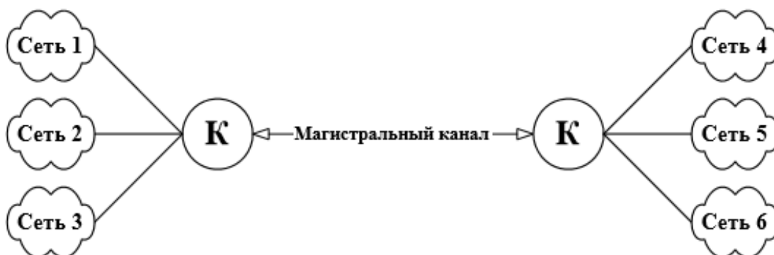
Рисунок 8 – схема подключения локальных сетей к коммутаторам
