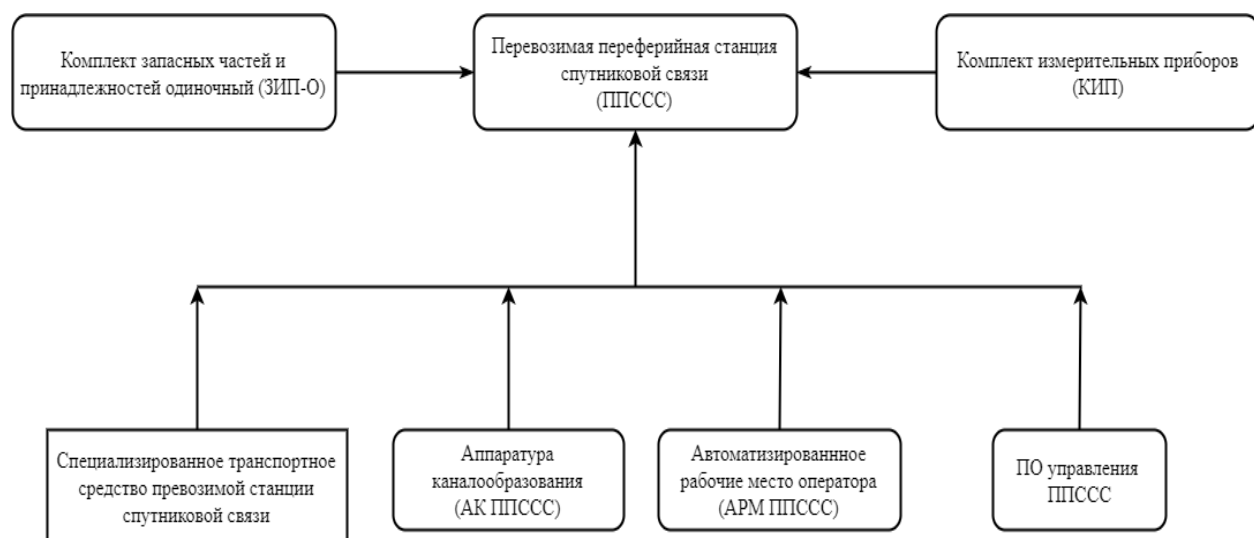
Рисунок 4 – Функциональная схема деления станции на составные части
