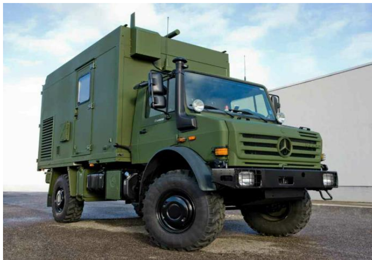
Рисунок 3 – Подвижный комплекс контроля Радиоэлектронной обстановки на базе: Mercedes-Bens Unimog U5000
