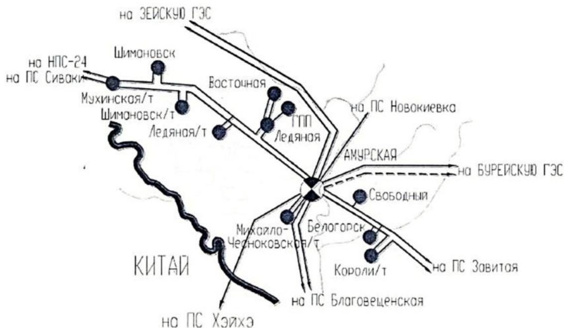
Рисунок 1 – Схема электрических сетей района размещения АГПЗ и АГХК
