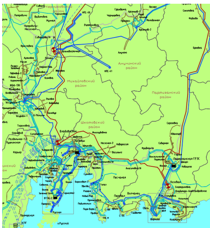
Рисунок 1 – Карта-схема размещения объектов генерации и электрических сетей 220 кВ и выше Южного энергорайона.
