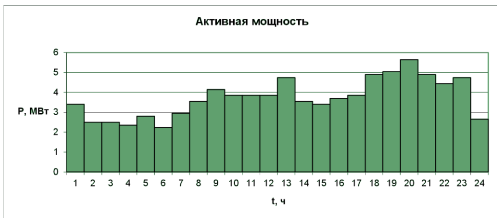
Рисунок 3 – Суточные графики активной и реактивной нагрузки ПС Хандыга
