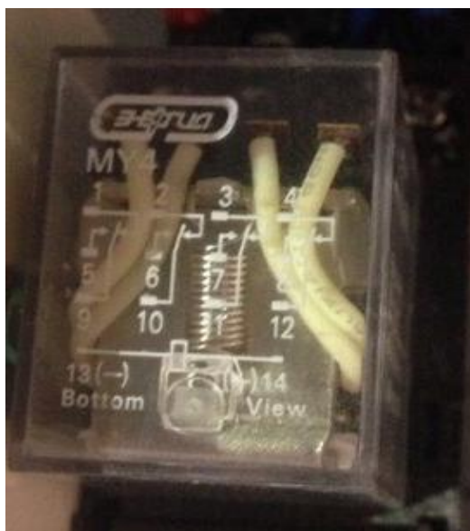
Рисунок 3.2 – Реле IEC255 3A 150 VAC
