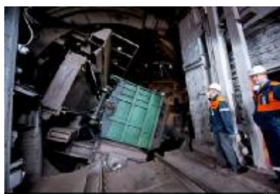
Рисунок 8 – процесс очистки полувагона от остатков угля
