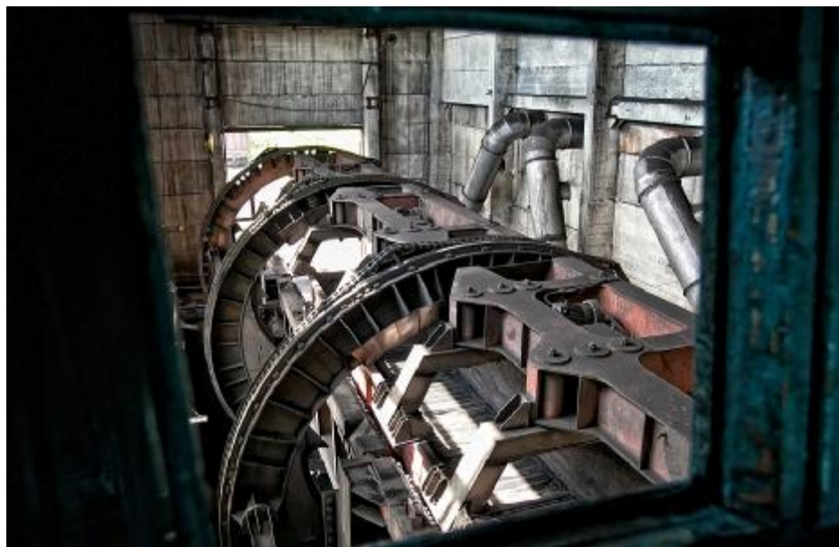
Рисунок 15-вагоноопрокидыватель типа ВРС-93
