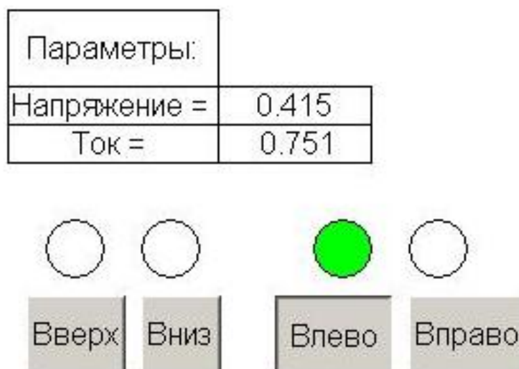
Рисунок 5.6–Экран визуализации в программе CoDeSyS для управления установкой
