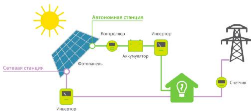
Рисунок 1.5 – Обобщённая схема комплекса автономной солнечной батареи
