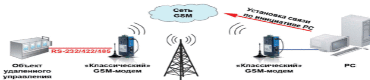
Рисунок 4.1 – Функциональная схема решения
