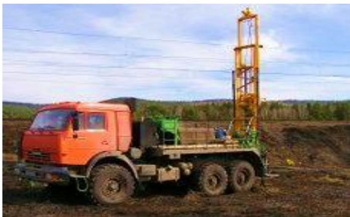
Рисунок 7 - Буровая установка «ПБУ-2» на базе автомашины «КАМАЗ»
