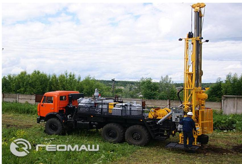
Рисунок 10 - Буровая установка «ПБУ-2» на базе автомашины «КАМАЗ»
