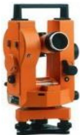
Рисунок 4 - оптический теодолит ЗТ5КП
