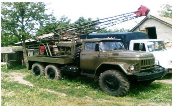
Рисунок 6 – Буровая установка «УГБ-1»
