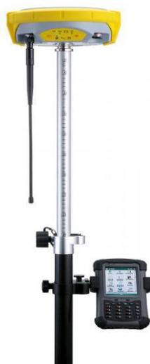
Рисунок 8 - Спутниковый приемник «Geomax Zenith 15»
