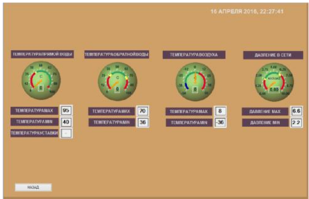
Рисунок 21 – Экран «показания приборов» в программе TraseMode
