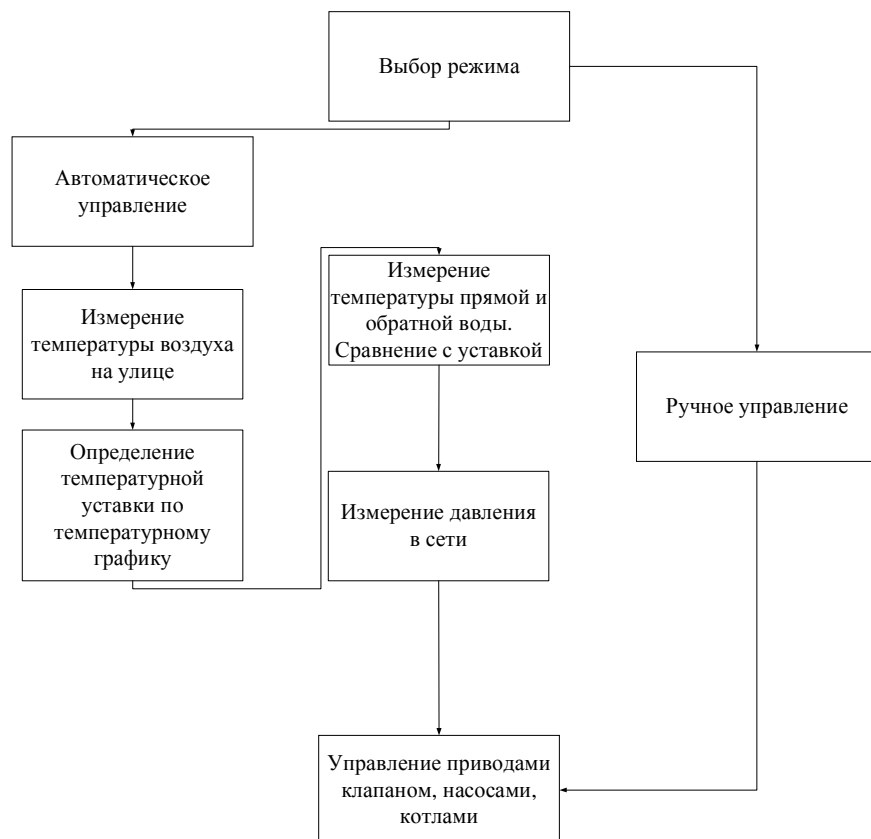
Рисунок 17 - Обобщенный алгоритм работы энергоустановки
