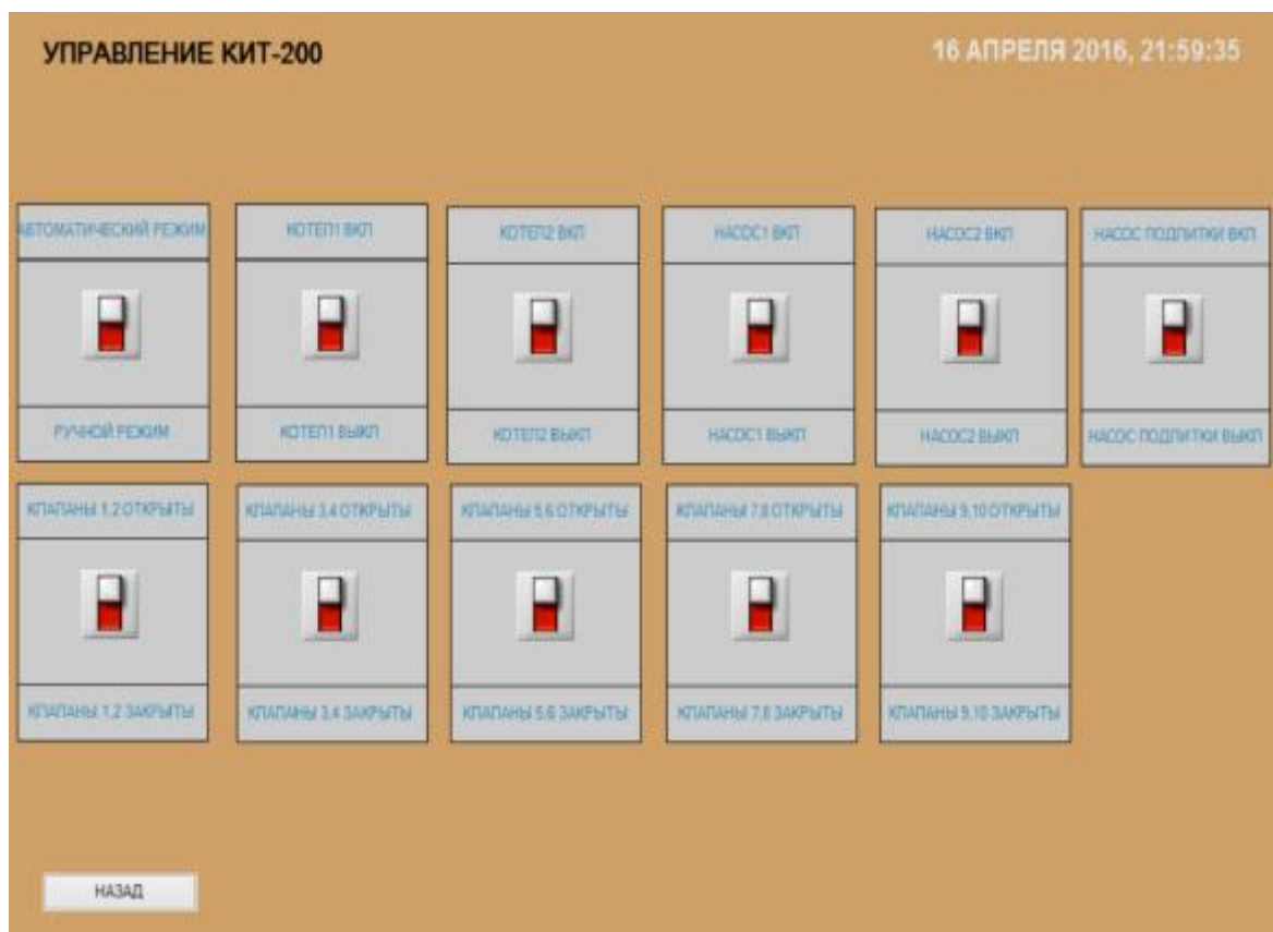
Рисунок 20 – Экран управления электродкотельной в программе Trace-Mode
