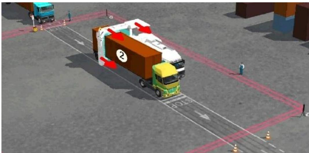
Рисунок 7 – Сканирование транспортного средства системой HCV-Mobile при движении вперед<sup>30</sup>
