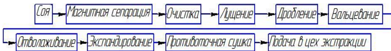
Рисунок 2 - Принципиальная схема технологического процесса предварительной обработки сои:
