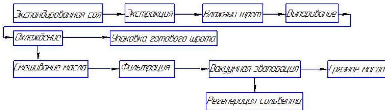
Рисунок 4 - Принципиальная схема технологического процесса цеха экстракции
