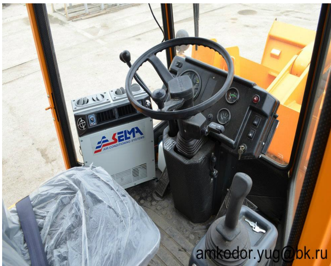
Рисунок 12 – Размещение кондиционера «SELMAVertical» в кабине
