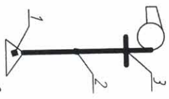
1 – панель, 2 – магистраль воздухохода, 3 – местные сопротивления.
