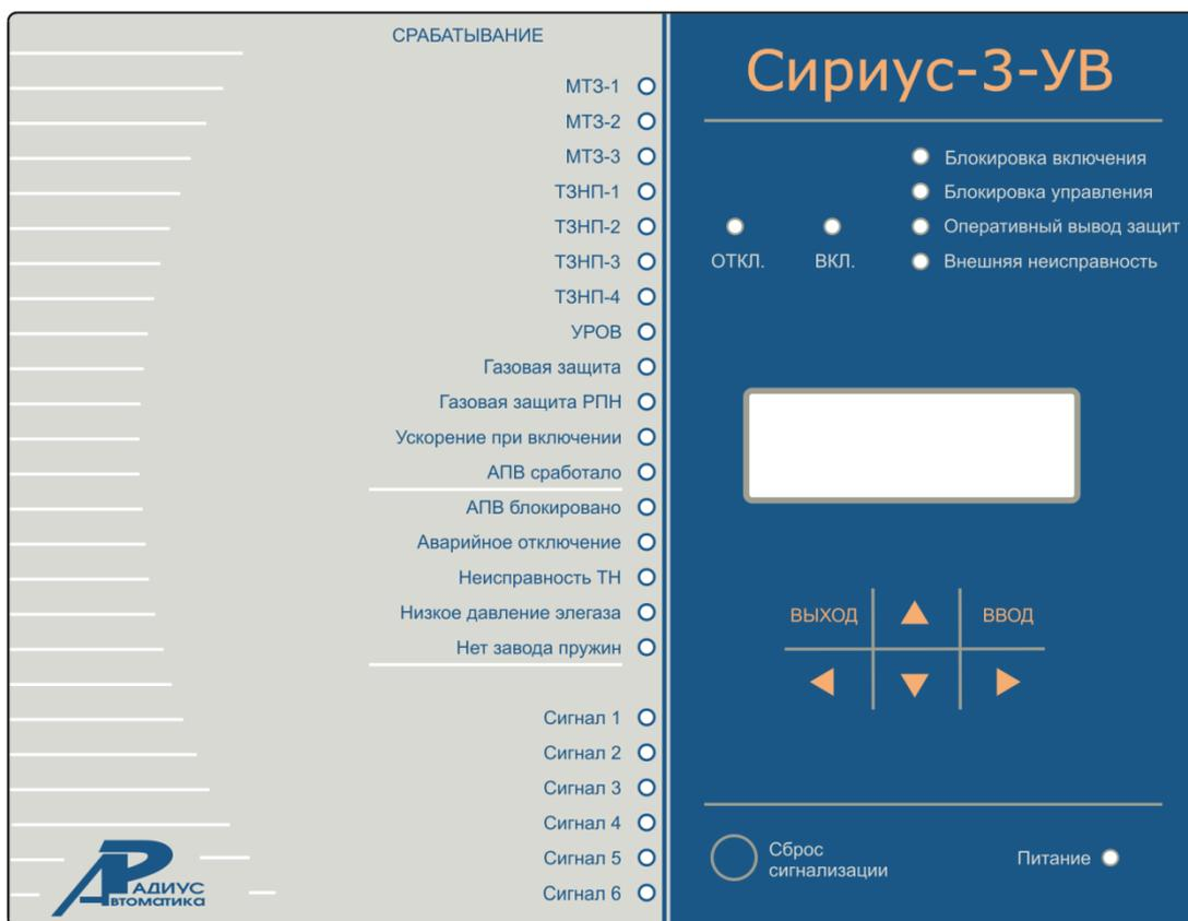
Рисунок 12 - Устройство микропроцессорной защиты «Сириус-3-УВ»
