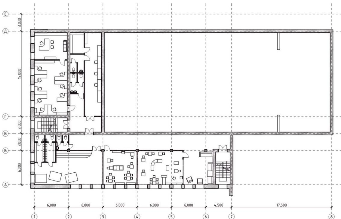
Рисунок В. 2 – План 2 этажа после реконструкции
