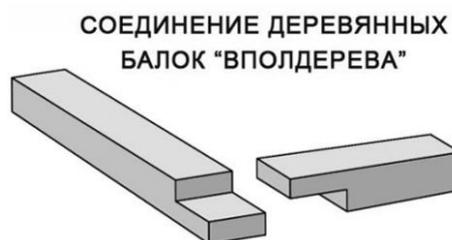
Рисунок 3.2 – соединение балок «вполдерева»
