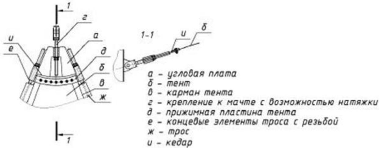
Рисунок В.11 – Узел крепления тентовой конструкции
