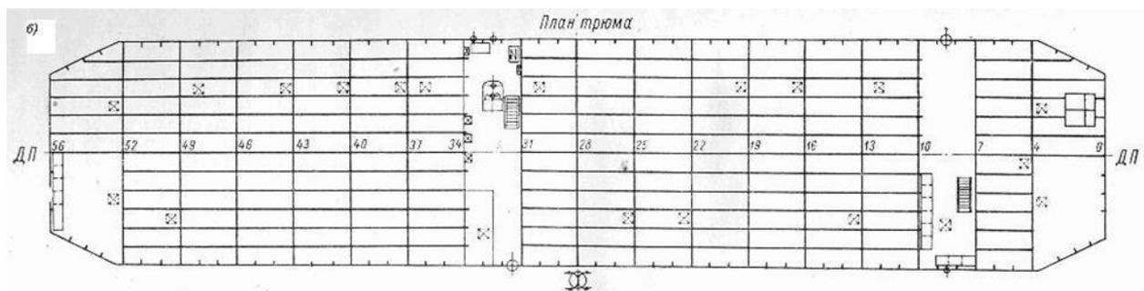
Рисунок А.5 - Конструкция корпуса дебаркадера длиной 65 м (план трюма) поздней постройки (после 1948 г)
