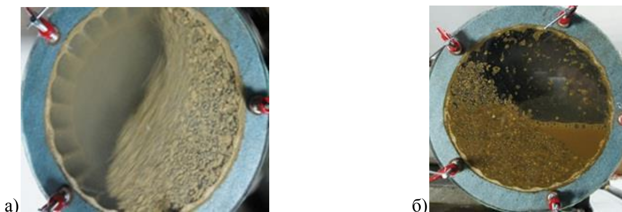
Рисунок 1 - Распределение шаров в среде измельчаемого материала в мельнице ПСИ: а – при сухом измельчении в обращённом движении; б – при мокром измельчении
