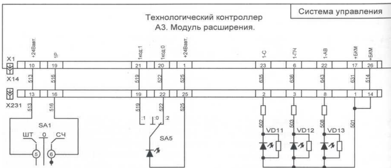
Рисунок 15 - Принципиальная схема цепей органов управления и индикации работы от СЧУ
