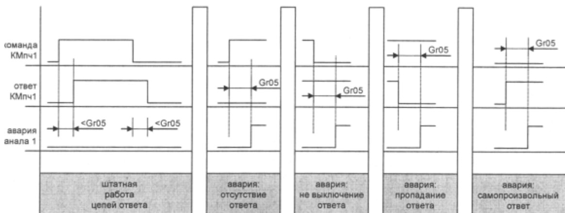
Рисунок 4 - Логика работы цепей ответа
