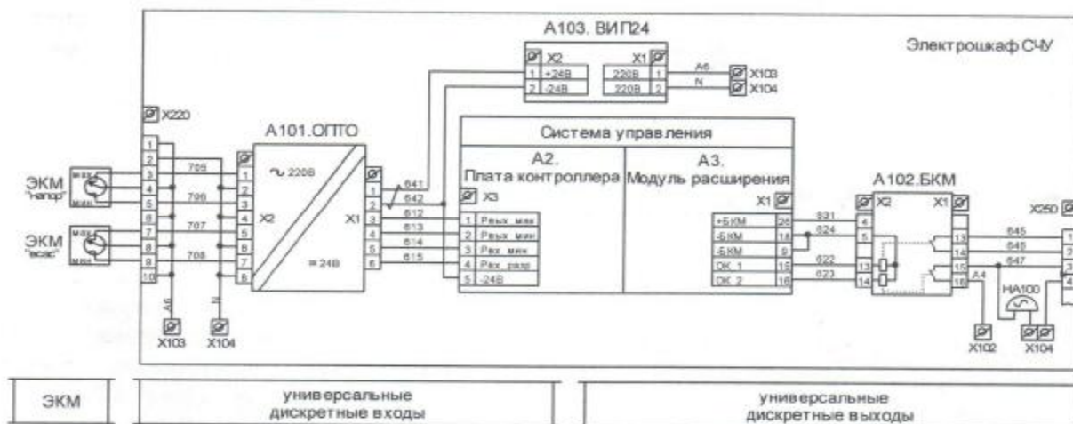
Рисунок 17 - Схема цепей дискретного интерфейса
