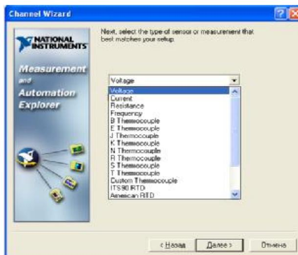
Рисунок 15 – Тип датчика измеряемой величины
