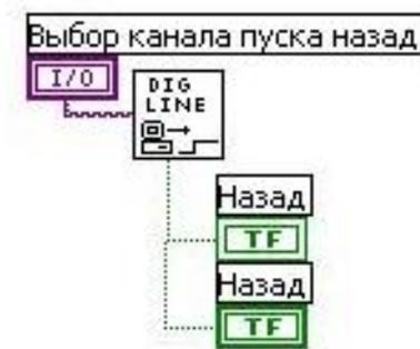
Рисунок 29 – Дискретный канал и объект WriteToDigitalLine
