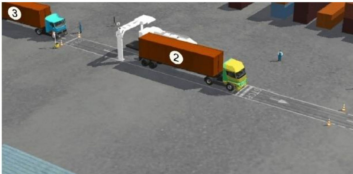
Рисунок 10 – Сканирование транспортного средства под стрелой системы HCV-Mobile.
