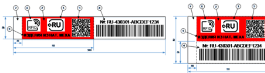
Рисунок 5 – Контрольный идентификационный знак, применяемый для маркировки импортных товаров, ввезенных на таможенную территорию РФ
