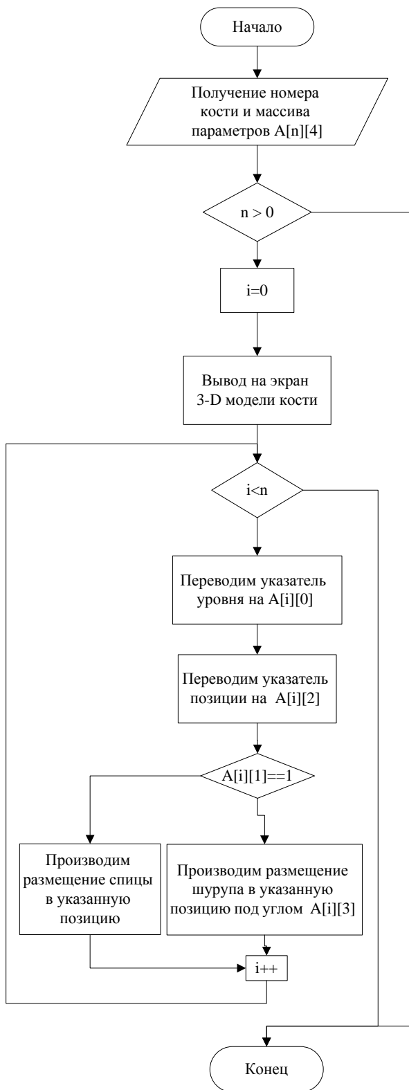
Рисунок 21 – Алгоритм работы блока визуализации фиксирующего устройства
