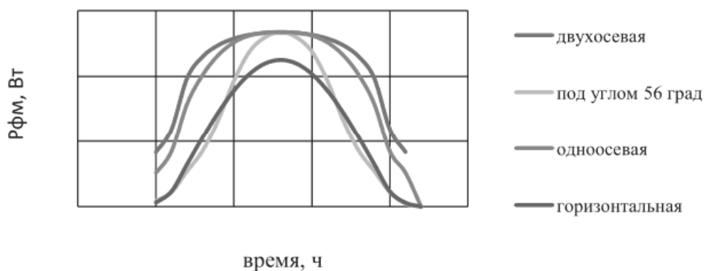
Рисунок 5 – График зависимостей вырабатываемой мощности солнечной батареи: расположенной горизонтально, с применением систем слежения и установленной под углом к горизонту (июль).
