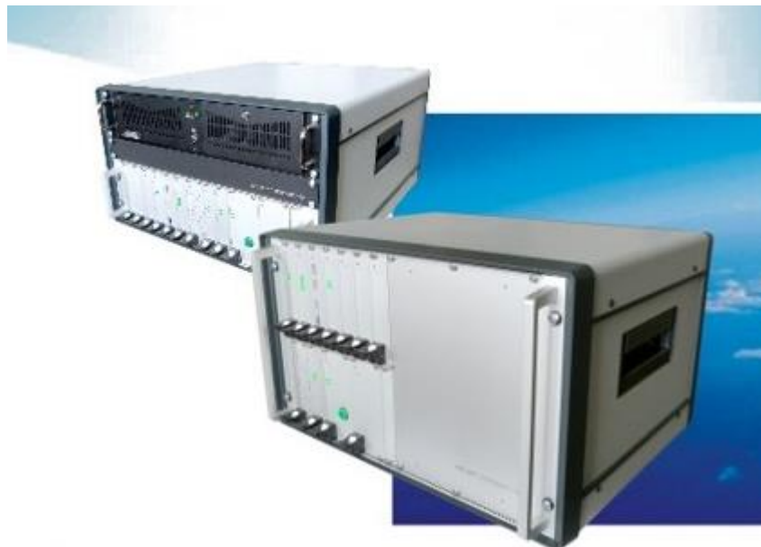
Рисунок 3 – Базовая станция системы радиозондирования «Полус-С»
