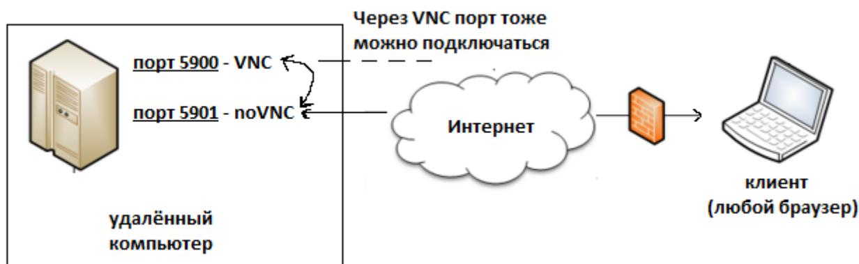
Рисунок 5 – Общая схема получения доступа к удаленному компьютеру
