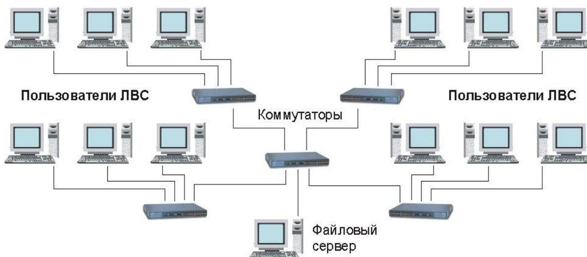
Рисунок 1 – Схема ЛВС.
