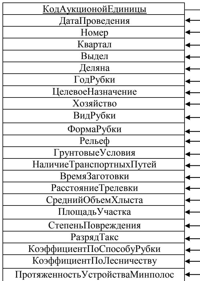
Рисунок 24 – Диаграмма функциональных зависимостей отношения «Аукционная единица»
