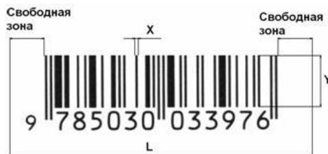
Рисунок 2 – Стандартный вид линейного штрихового кода. Иногда под штрихами печатаются закодированные цифры
