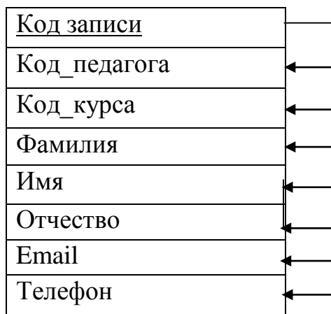
Рисунок 24 – Диаграмма функциональных зависимостей отношения «Записи»
