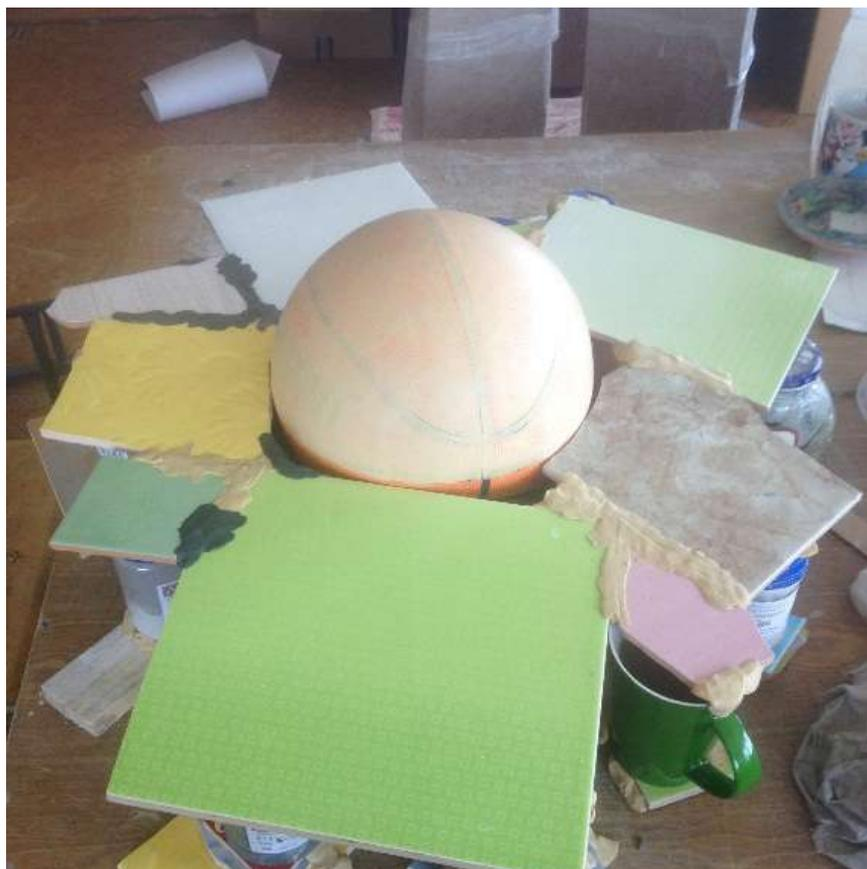
Рисунок Ж.6 Подготовка создания гипсовой формы для отминки шара
