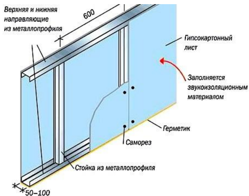
Рисунок Д.1 - Конструкция гипсокартонной перегородки
