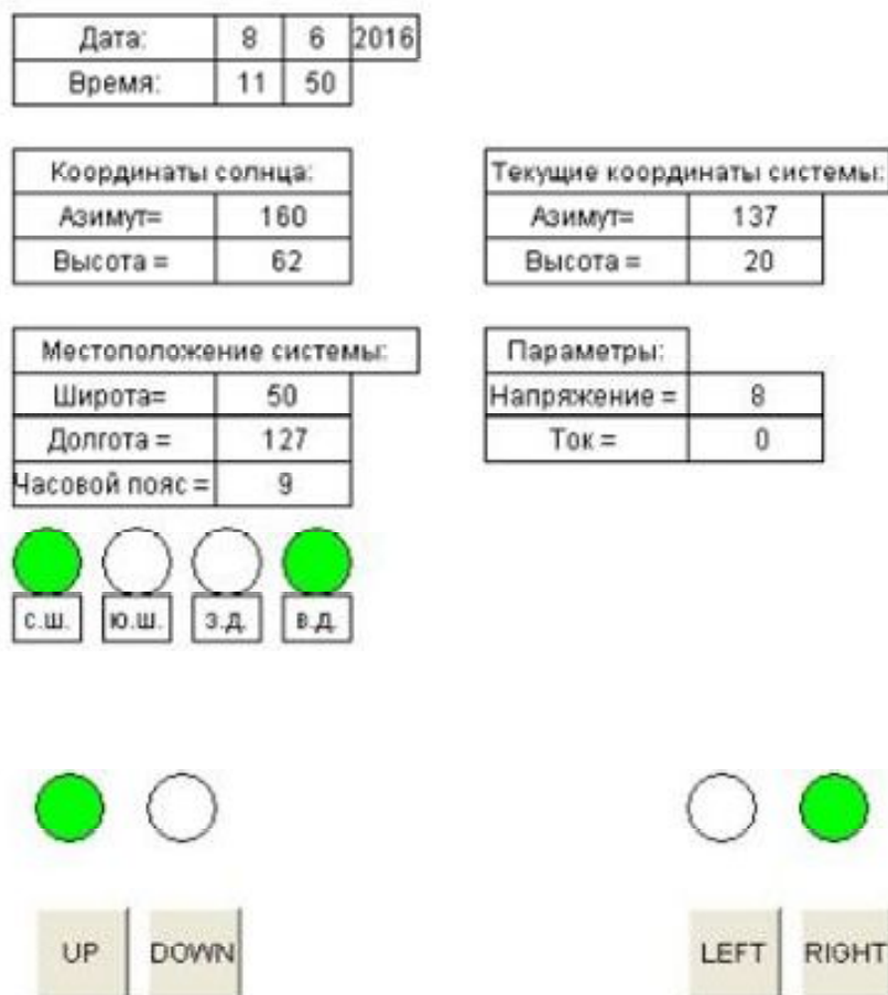
Рисунок 38 – Экран визуализации в программе CoDeSySv2.3 для управления электроприводами и отображения параметров солнечной батареи
