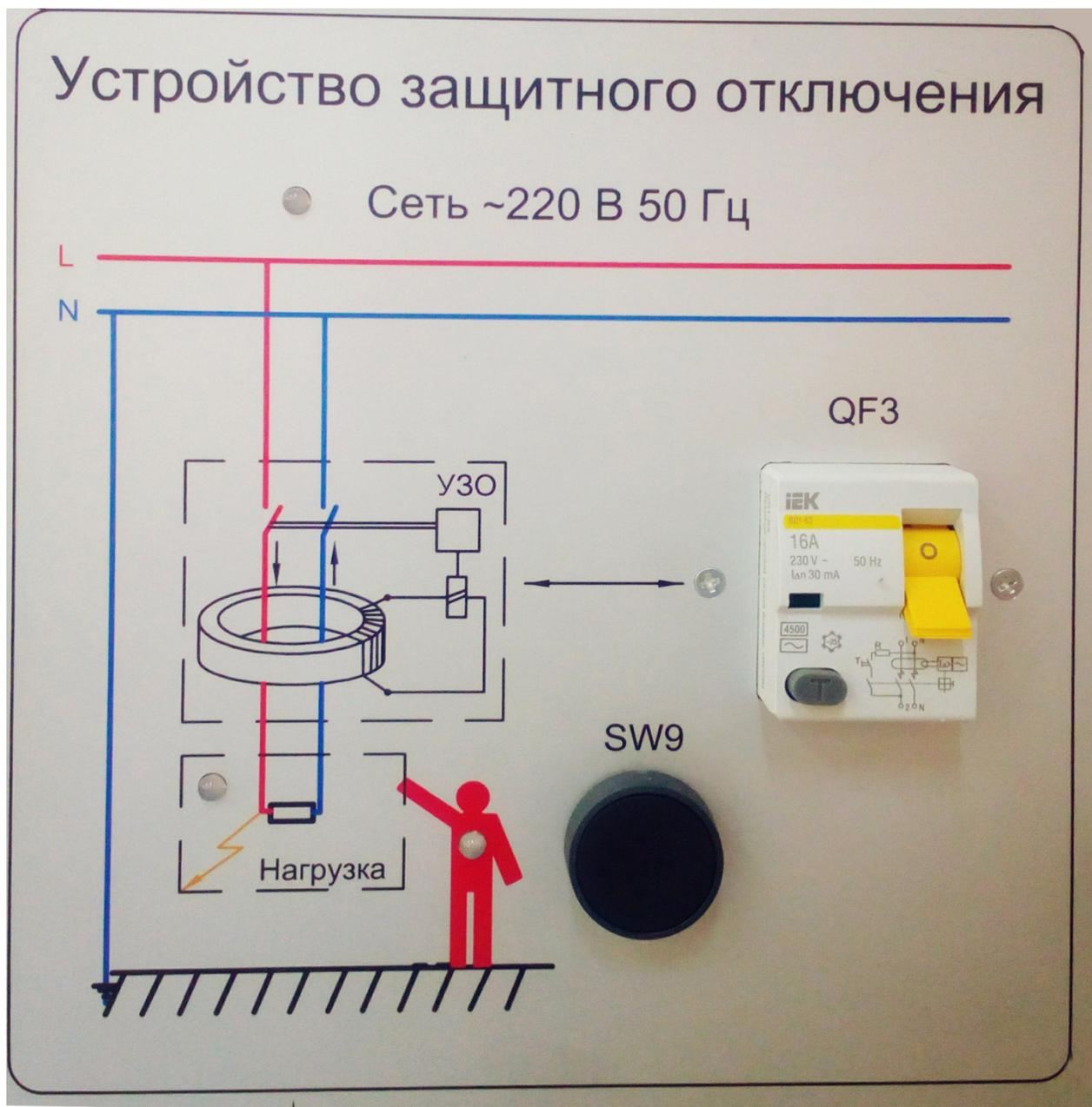
Рисунок 32 - Модуль УЗО
