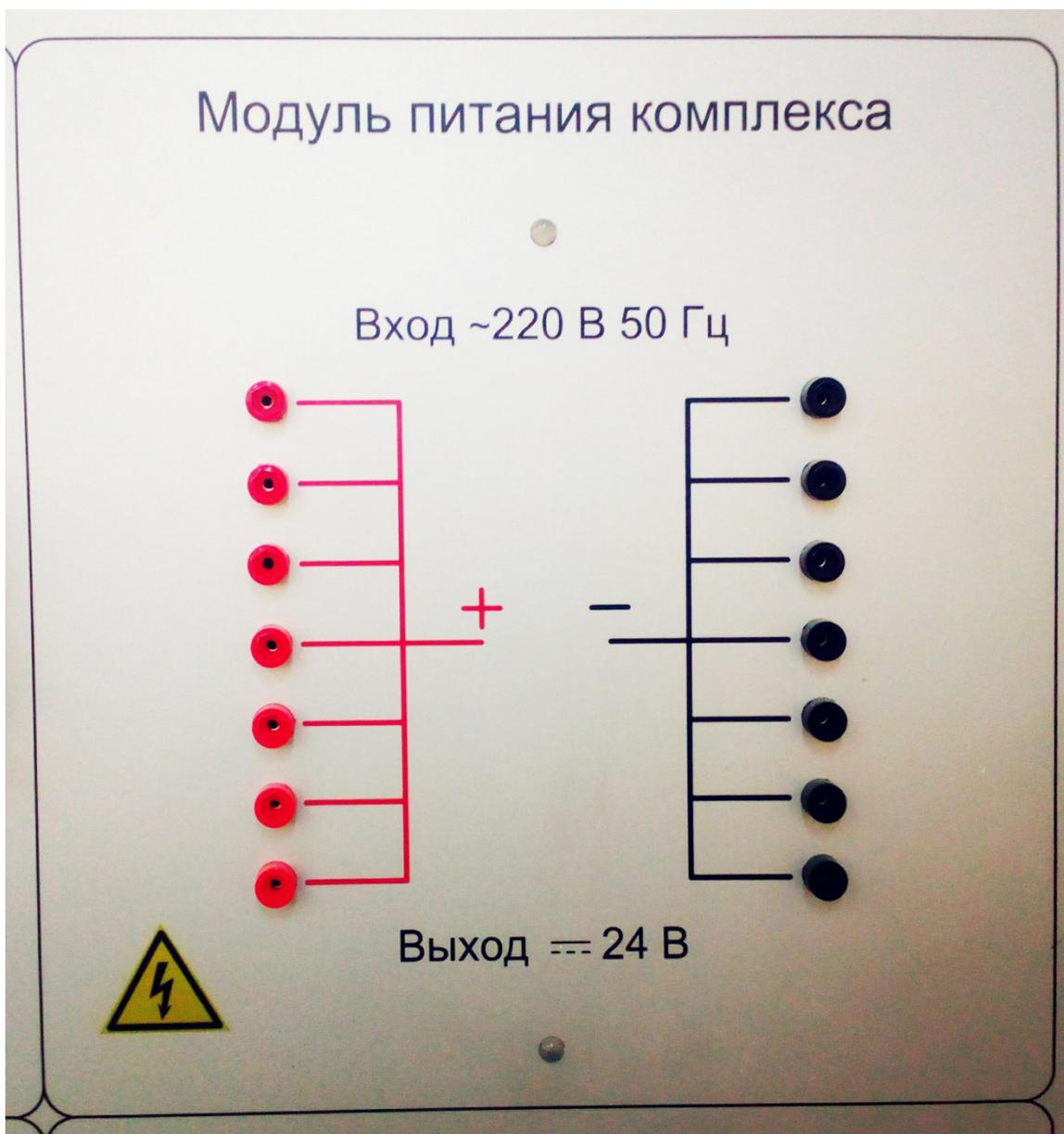
Рисунок 27 - Модуль питание комплекса
