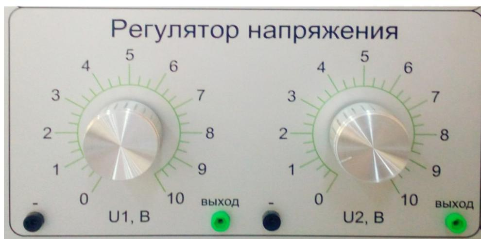
Рисунок 35 - Регулятор напряжения
