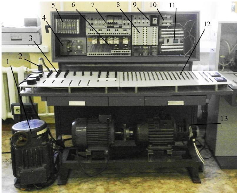
1 - регулятор напряжения, устройство, предназначенное для поддержки в требуемых пределах значения напряжения потребителя электрической энергии;
