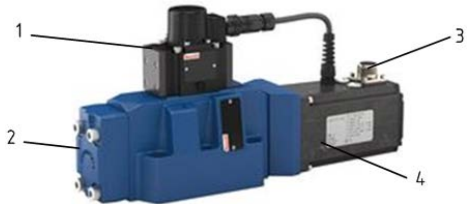
Рисунок 29 – Клапан – распределитель: 1 – электрическая сервомашинка, 2 – блок клапанов распределителей, 3 – разъем подключения управляющих сигналов, 4 – блок обратной связи по положению клапана
