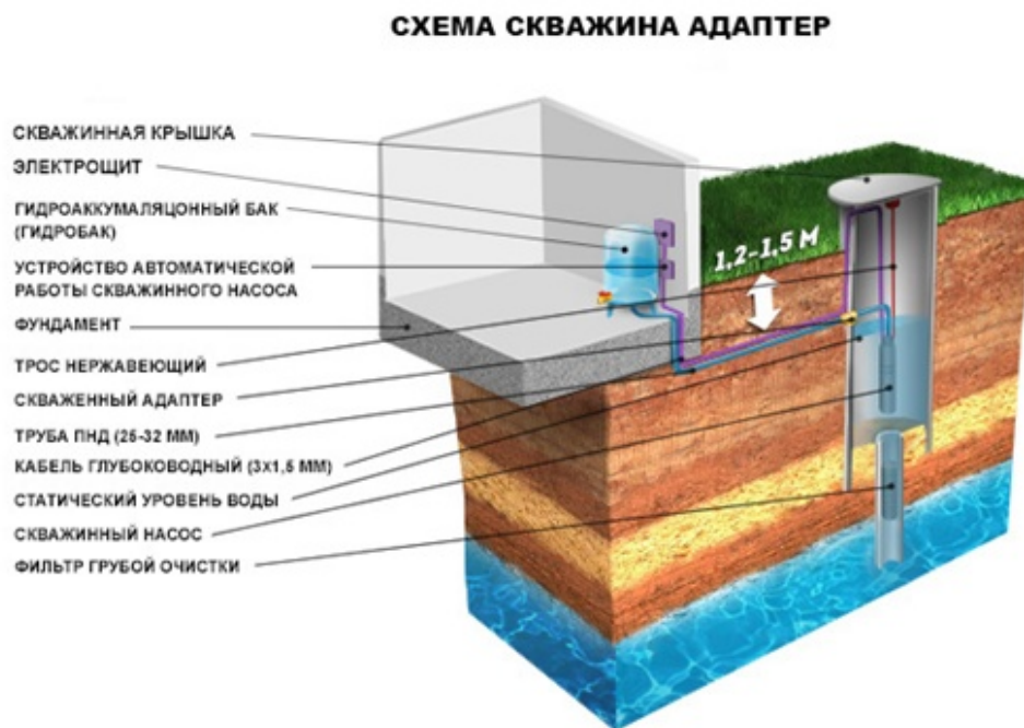
Рисунок 17– Обустройство скважины с адаптером
