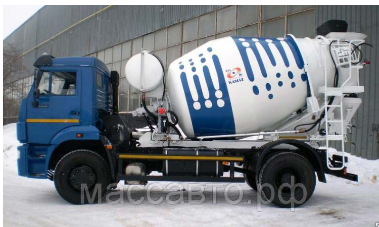
Рисунок 3 – Автобетоносмеситель Туймазы (АБС-5)
