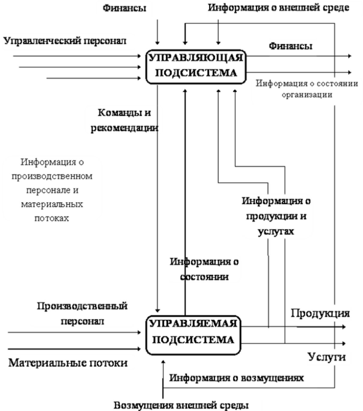
Рисунок А.1 – Схема взаимодействия управляемой и управляющей подсистем предприятия
