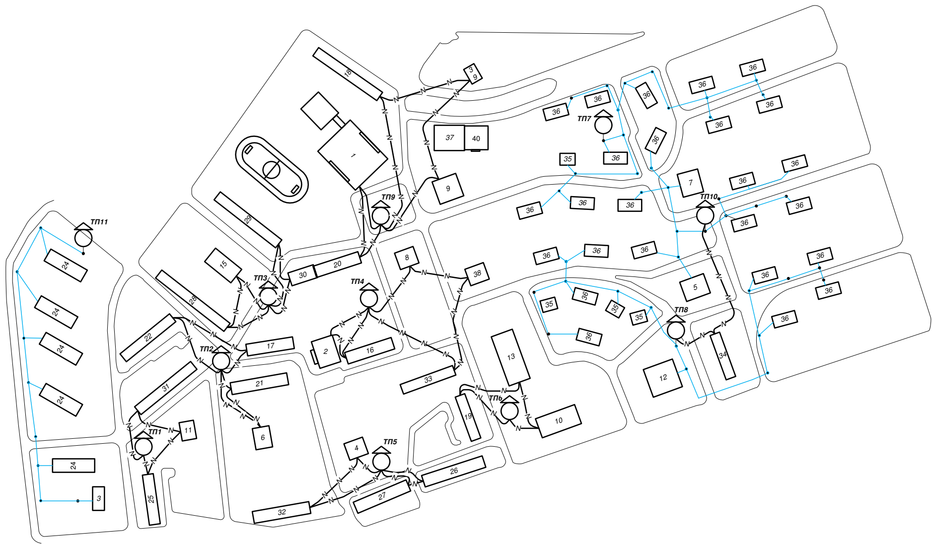
Рисунок 2 – Схема электроснабжения потребителей 0,4
