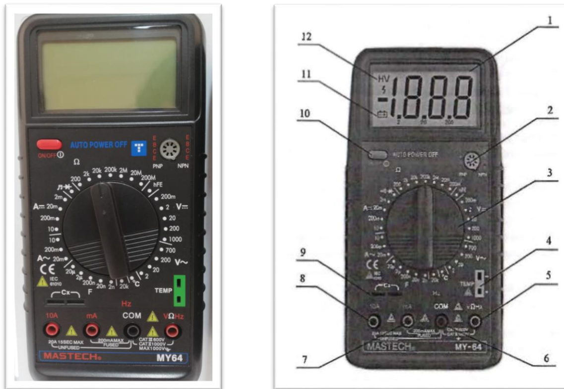
Рис. 3. Мультиметр Mastech MY64 , внешний вид: 1 – дисплей; 2 – разъем для подключения транзисторов; 3 – переключатель режима измерения; 4 – разъем для подключения термопары; 5 – гнездо «VΩHz» для подключения измерительного щупа или соединительного проводника при измерении напряжения, частоты или сопротивления; 6 – гнездо «COM» для подключения измерительного щупа или соединительного проводника при измерении напряжения, силы тока, частоты или сопротивления; 7 – гнездо «tA» для подключения измерительного щупа или соединительного проводника при измерении силы тока до 200 мА; 8 – гнездо «10 А» для подключения измерительного щупа или соединительного проводника при измерении силы тока до 10 А; 9 – разъем для подключения конденсатором при измерении их емкости; 10 – кнопка включения/отключения питания; 11 – индикатор низкого заряда батареи (лабораторный мультиметр питается от сети 220 В через AC/DC преобразователь, поэтому не нуждается в замене батареи); 12 – индикатор, отображающий, что мультиметр работает в режиме измерения высокого напряжения.
