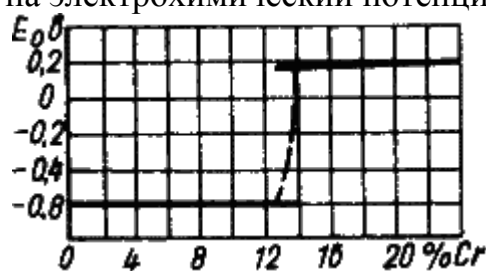
Рис 16.1. Влияние хрома на потенциал сплавов Fe-Cr
