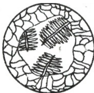
Рис. 2.4. Схема кристаллизации хлористого аммония
