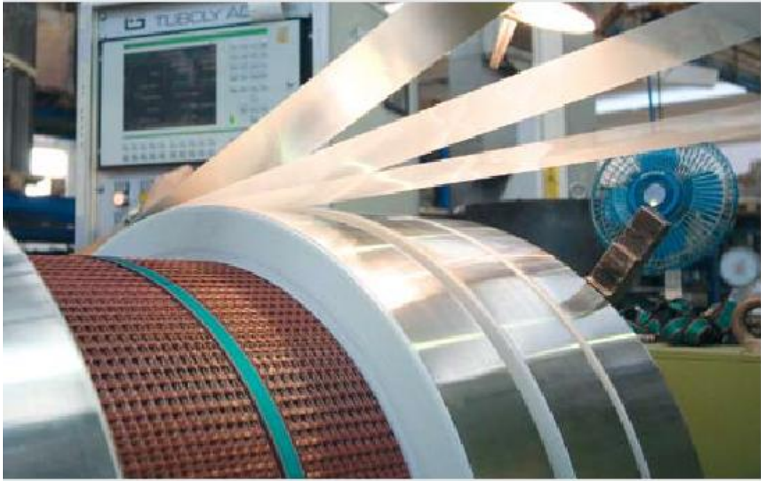
Рис. 2. Изготовление обмотки высокого напряжения
