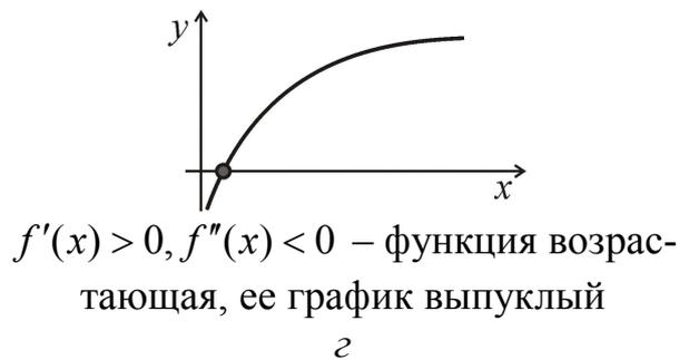
Рис. 2.4. Геометрическая иллюстрация локализации корня и возможностей поведения функции  $f(x)$  в окрестности корня.
