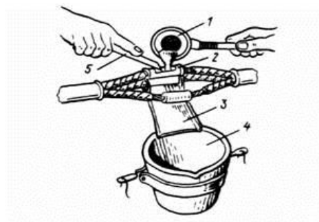
Рисунок 20. Соединение жил пайки поливом расплавленного припоя:
